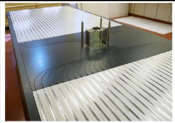
**Detectores enterrados a 2.3 m, segmentados en 192 partes con área total de 30 m<sup>2</sup>**
